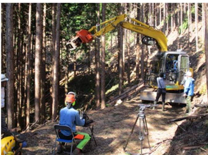
第1回の実証試験後、アームの先にあるグラップル操作ができる機能を開発し、第2回目の実証試験で全ての機能が稼働するかを検証した。
