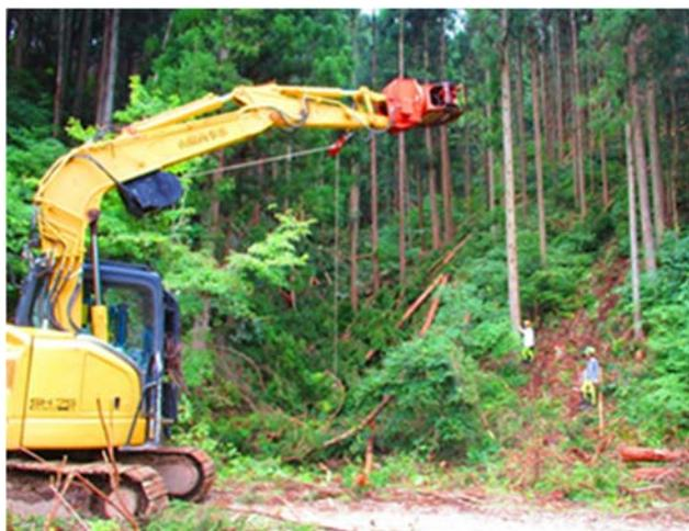
林材にロープをかけて山から降ろす集材を遠隔操作で実践。林材状況によって繊細なアームのコントロールが求められる。
