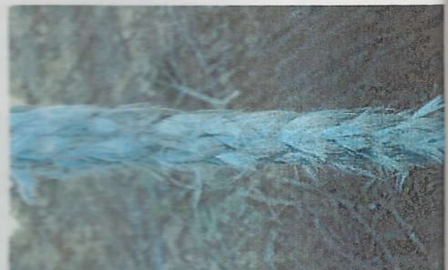
磨耗によるザイルの損傷
