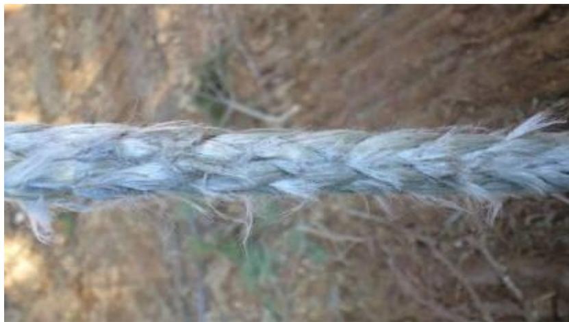
図 17 摩耗によるザイルの損傷
