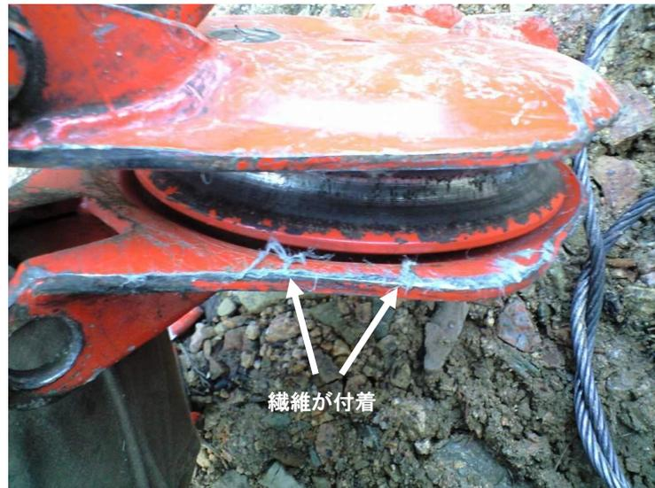
図 16 金属器具との接触による磨耗
