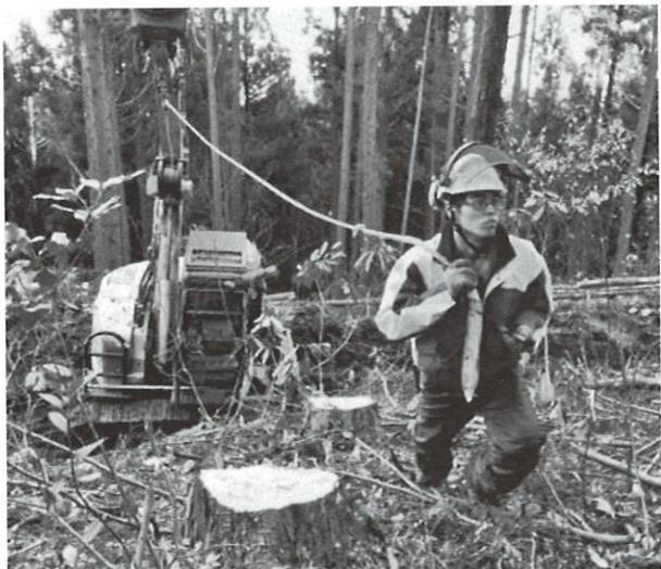
写真-7 纊維ロープを引いて斜面を上がる作業者
